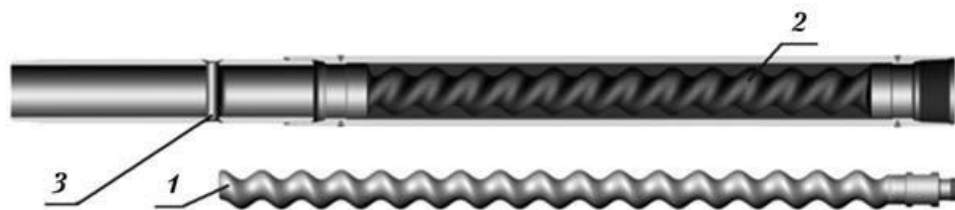
1-ротор; 2-статор; 3 - отырғызу келте құбыры
